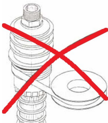
Figura 2.18: No utilizar teflón en las juntas
